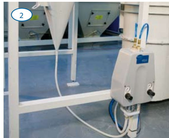
2 Насос плотной фазы HDLV® повышает эффективность системы рекуперации.
